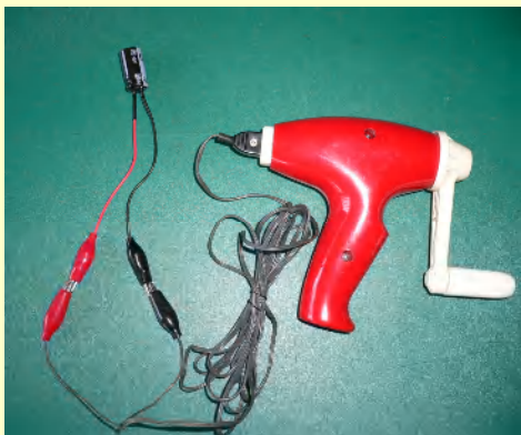
手回し発電機によるコンデンサへの蓄電の様子
